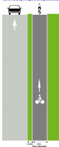
Schéma de principe d'une piste unidirectionnelle.
